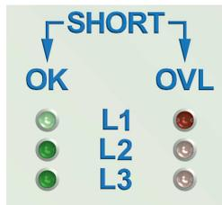
Leuchtet eine **rote LED** auf, ist der ICT 2.3 in der entsprechenden Phase überlastet. Bei einer Überlastung wird die Funktion **AUTOMATISCHER KURZSCHLUSS** des sekundären Messkreis aktiviert.
