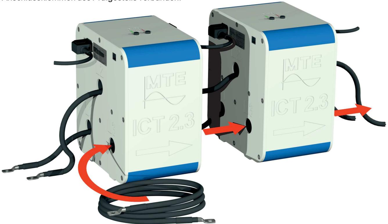
Der sekundäre Anschluss jeder Phase erfolgt mittels eines Stromkabels, wobei die gleiche Stromrichtung wie der sekundäre Messkreis beachtet werden muss. Bei einer Neulieferung einer Prüfstation ist die Länge der Kabel für die Verwendung mit und ohne ICT's ausgelegt.
