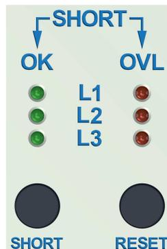
Die **SHORT** Taste schaltet die Kurzschluss-Funktion für alle 3 Phasen gleichzeitig ein. Die Funktion dient der Überbrückung von nicht verwendeten Messplätze.
