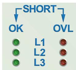
Wenn alle **roten oder grünen LED** zur gleichen Zeit aufleuchten, ist die Funktion **MANUELLER KURZSCHLUSS** eingeschaltet.
